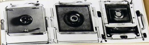
Corps avant du Sinar, avec l'objectif monté sur une planchette carrée.
